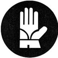
Verletzungsgefahr für Hände: zusätzliche Schutzausrüstung muss getragen werden (Handschuhe)
