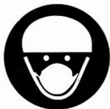
Inhalationsgefahr des Schleifstaubes, sowie Gefahr des Haarverfangens: zusätzliche Sicherheitsausrüstung muss getragen werden (Maske und Helm).
