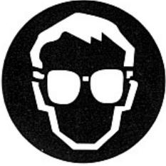
Gefahr der Verletzung der Augen: zusätzliche Schutzausrüstung ist erforderlich (Schutzbrille)
