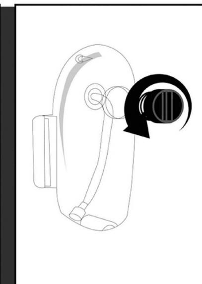
Drehen Sie die -Kappe gegen den Uhrzeigersinn und entfernen Sie sie.
