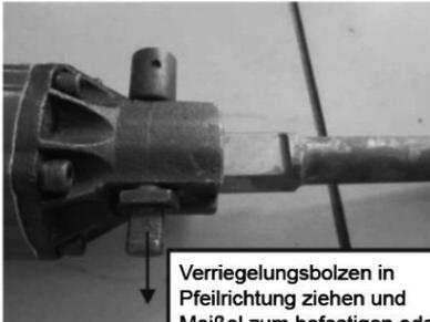
Verriegelungsbolzen in Pfeilrichtung ziehen und Meißel zum Befestigen oder Entfernen um 180° drehen.
