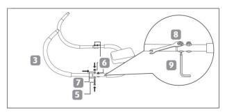
3.Setzen Sie den oberen Teil von Rahmen 2 in den mittleren Rahmen ein. 3.Befestigen Sie die Verbindung mit den Schrauben , den Unterlegscheiben und den Bolzen 6.Verwenden Sie zur Befestigung den Schlüssel und den Inbusschlüssel .
