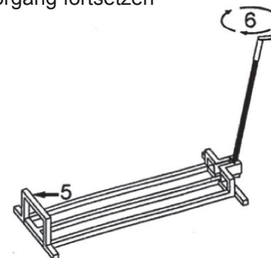
Falls der Mäher schief gehoben wird, drehen Sie die Kurbel gegen den Uhrzeigersinn, um den Mäher wieder auf den Boden zu stellen. Positionieren Sie den Mäher dann korrekt und beginnen Sie erneut mit dem Hebevorgang.
