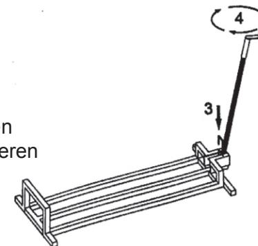
5. Den Mäher über dem Heber positionieren, die Basis des Mähers parallel der seitlichen Verstärkung gegenüber der Kurbel festsetzen
